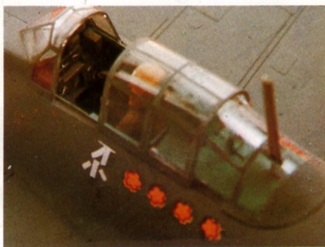
La carlinga dello ZERO con particolari autentici ha i pannelli laterali e frontali con gli strumenti, il sedile del pilota, la leva di comando e la pedaliera del timone.
