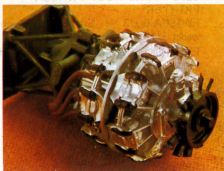
Superbamente ricco di dettagli il BMW 801 a motore stellare mostra i particolari esterni e di montaggio del motore.
